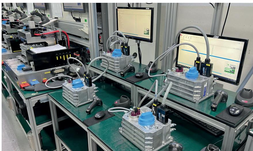
**Delta Energy Systems schützt offene Anschlüsse und empfindliche Kontakte seiner Produkte mit Kappen aus Kunststoff von Pöppelmann KAPSTO.** © Delta Energy Systems
